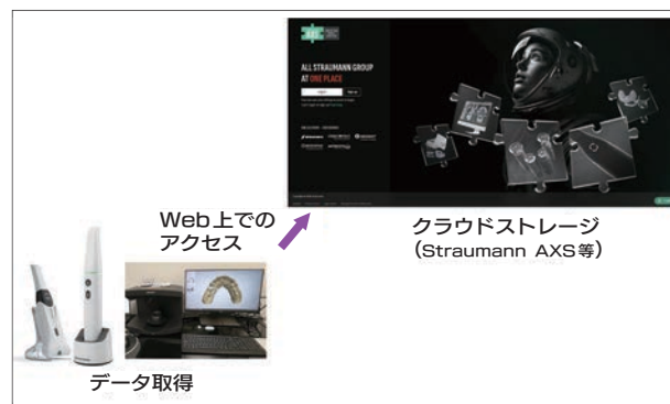
図3 クラウド保存。院内機器とそれに接続するPCからWeb上のクラウドストレージにデータを送信し、保存する。それにより、どこにいてもどのPCを用いてもデータへのアクセスが可能になる。
