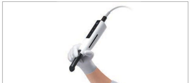
図10 AccuioSは, エアブローシステムが搭載されたモリタ製作所製のスキャナーである。
