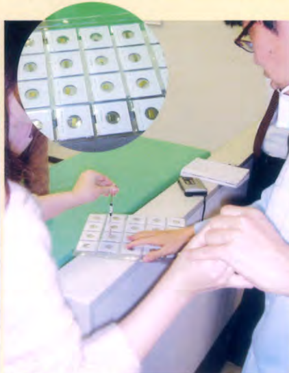
金属サンプルとの相性もオーリングを使いチェックしている
