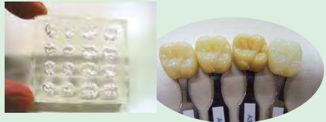
根岸さんが開発し、発売が予定されている「シェードガイドフォーマー」(発売元:サイブロン・デンタル(株))。透明なラバー製で光の透過があり、フォーマーに光重合レジン詰めて光重合することが可能。レジン製のカスタムシェードガイド(写真右)が容易に製作できる。咬合面のフォルムは咬合するように作られているので、光重合レジンのみではなく、即時重合レジンを用いて白歯部TEKを製作したり、白歯部のWAX-UPをすばやく行うことも可能だ
