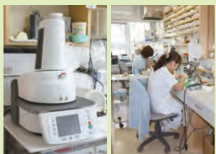
プレスとセラミックスファーマネスの両方に使用できるコンビネーションファーマネス器を備えた技工室
