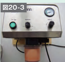
水に粉を投入して予備練和を行い、真空練和器で練和する。練和時間は45秒以上とする。
