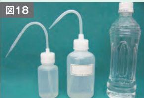
石膏の練和に使用する水は常温水を使用する。
