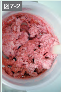
練和カップには水を計量して先に投入し、次いで粉を投入後、予備練和を行い、水と粉をなじませる。
