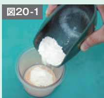
水に粉を投入して予備練和を行い、真空練和器で練和する。練和時間は45秒以上とする。
