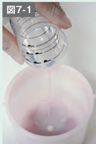
練和カップには水を計量して先に投入し、次いで粉を投入後、予備練和を行い、水と粉をなじませる。
