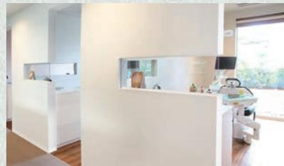
廊下の窓はプライバシー保護のため患者が歩くときの目線より低くしているが、準備室からは様子が見える高さになっている
