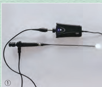
●内視鏡に固定光源を接続した様子。 電源が必要だが、明るく見やすい (接続できる各種機材には限りがあります)
