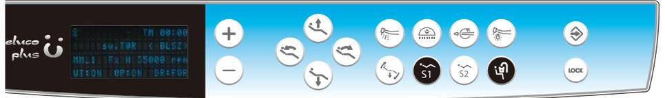
シンプルで機能的なデザインのタッチパネルが効率的なユニットコントロールを実現。マイクロモーター回転表示やタイマーの設定状況などを表示するVFDモニターを標準装備しています。
